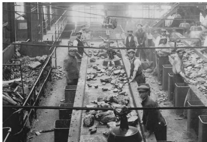
Fig.2. Sorteerruimte van de mijn van Eisden, tijdens het interbellum. Elk kolenwagentje dat uit de mijn tevoorschijn kwam was geladen met een mengsel van kolen, steen en hout. Aanvankelijk verwijderden leerjongens en soms ook vrouwen hieruit manueel het hout en de stenen. Later gebeurde dit machinaal in de kolenwasserij (Archief Hasselt)
