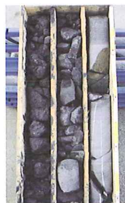
Foto 2 : Boorkern in schacht C, gelegen op de linkermaasoever te Lixhe (diepte 6.20-8.90 m) met van boven naar onder (in de kernkist van linksboven naar rechtsonder) een grote kei uit het Maasgrind, vervolgens wit uitslaande mergelige klei en donkerbruine zandige klei vol ingekoold fijn plantenhaksel, behorend tot de Formatie van Aachen (basislagen van het Krijt). De klei is goed herkenbaar aan de krimp-scheuren die door uitdroging zijn ontstaan. Onder het houten tussenschotje komt massieve bleekgrijze siliciet voor, naar onder toe vertikaal gespleten, met een roestfilm op het splijtvlak, achtergelaten door insijpelend water. De siliciet is ontstaan door secundaire verkiezeling van de fossiele bodem ('paleosol') die zich tijdens het Krijt op de Karboongesteenten heeft ontwikkeld, en die door zijn grote hardheid de onderliggende zachte paleosolgesteenten tegen erosie heeft beschermd. Onderaan de boorkern wordt het gesteente zachter en brokkelig, getuige van de overgang naar de meer verkrumelde paleosol.
