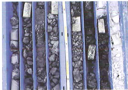
Foto 3 : Boorkern uit de horizontaalboring volgens het traject van de tunnel onder het Albertkanaal, uitgevoerd vanuit schacht A, gelegen op de linkeroever van het Albertkanaal te Loën (afstand vanuit schacht 155-175 m, van rechtsboven naar linksonder in de kernkisten). Voorbeeld van zonering in de paleosol en contact met het kalksteenmoedergesteente. De kern vangt aan in witte gekaoliniseerde, aardeachtig verkrumelde siliciet, getuige van een extreme uitloging in
