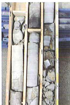
Foto 2 : Boorkern in schacht C, gelegen op de linkermaasoever te Lixhe (diepte 6.20-8.90 m) met van boven naar onder (in de kernkist van linksboven naar rechtsonder) een grote kei uit het Maasgrind, vervolgens wit uitslaande mergelige klei en donkerbruine zandige klei vol ingekoold fijn plantenhaksel, behorend tot de Formatie van Aachen (basislagen van het Krijt). De klei is goed herkenbaar aan de krimp-scheuren die door uitdroging zijn ontstaan. Onder het houten tussenschotje komt massieve bleekgrijze siliciet voor, naar onder toe vertikaal gespleten, met een roestfilm op het splijtvlak, achtergelaten door insijpelend water. De siliciet is ontstaan door secundaire verkiezeling van de fossiele bodem ('paleosol') die zich tijdens het Krijt op de Karboongesteenten heeft ontwikkeld, en die door zijn grote hardheid de onderliggende zachte paleosolgesteenten tegen erosie heeft beschermd. Onderaan de boorkern wordt het gesteente zachter en brokkelig, getuige van de overgang naar de meer verkrumelde paleosol.
