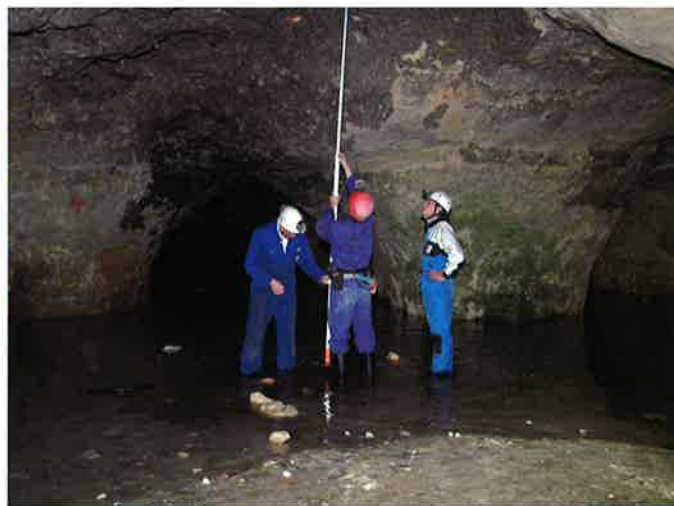
Figuur 12. Topografische opmeting in het ingangsgedeelte van de Waterkuil, aan de waterrand. De stijghoogte van het grondwater is af te meten aan de bruine verkleuring op de wand. De donkere oppervlakten tegen het dak zijn nog de oorspronkelijk bekapte oppervlakken. Elders is mede onder invloed van mos en wierbegroeiing (groene zone), door drukontlasting en wegvallen van wrijvingskracht het oorspronkelijke gewelf afgeschilferd. (foto Jeroen Verspreet)
