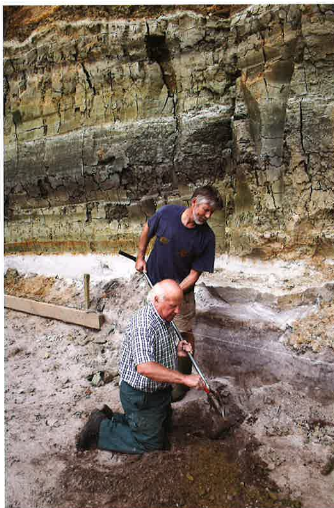
Figuur 5. Gebruik van de handboor voor de controle en identificatie van het onderliggende zandpakket. Let op de harde zandsteenlens in het witte zand en het voorkomen van witte kalkrijke bandjes in de groene klei.
