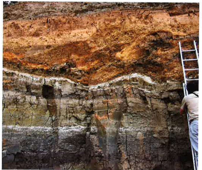
Figuur 25. Contact tussen het vergleden complex en de top van de klei van Henis met plastisch vervormde witte mergellaagjes (oostelijke wand van de bouwput).
