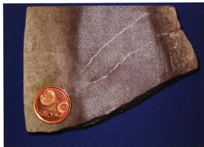
Figuur 18. Schijfje gezaagd uit de zoetwaterkwartsiet, met een poreuze onvolledig verkiezelde buitenzone (donker want nog vochtig) en een harde, volledig verkiezelde kern.
