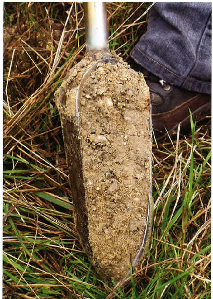
Figuur 12 b. Lepelboor-monster boring 43E0337, diepte 200-220 centimeter onder maaiveld, met grof grijs klei- en grindhoudend zand van fluviaatiele oorsprong, ontstaan in de reducerende zone maar tegenwoordig boven de zomerstand van het grondwaterpeil.
