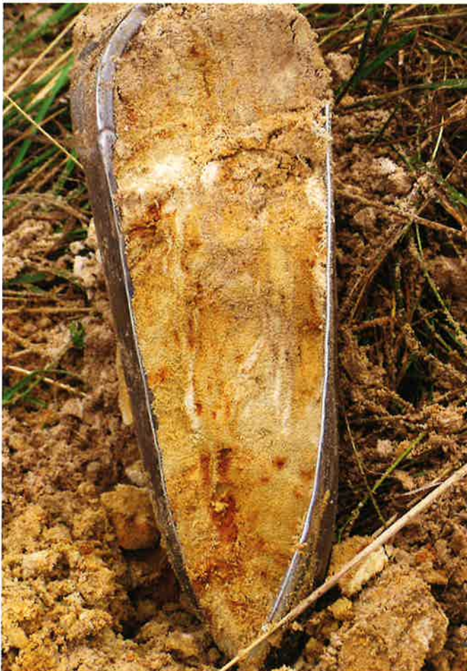
Figuur 12 a. Lepelboor-monster boring 48E0335, diepte 60-80 centimeter onder maaiveld, met fijn geelwit mul zand van eolische oorsprong, doortrokken door witte en roestige vlekken en strepen als gevolg van bodemvorming (neerslag van ijzeroxides in podzolbodem).
