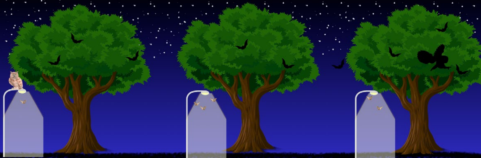
Schematische voorstelling van positie armaturen onder boomkruinen. Het is belangrijk een deel van de kruin niet te verlichten
